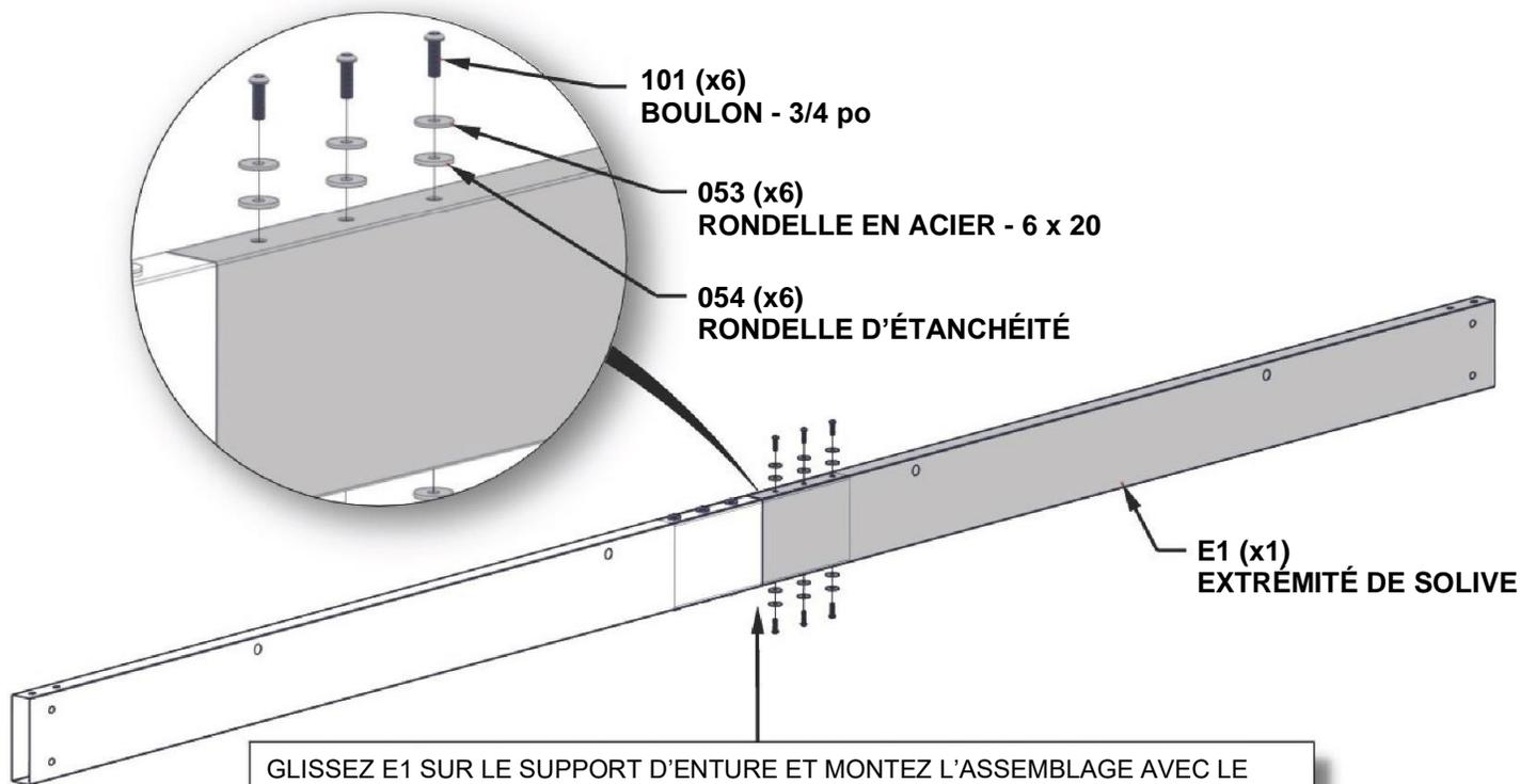
GLISSEZ E1 SUR LE SUPPORT D'ENTURE ET MONTEZ L'ASSEMBLAGE AVEC LE CARTON D'EMBALLAGE EN DESSOUS. TAPEZ DOUCEMENT L'ASSEMBLAGE SUR LE CARTON JUSQU'À CE QUE L'ÉCART SE FERME ET SERREZ TOUS LES
