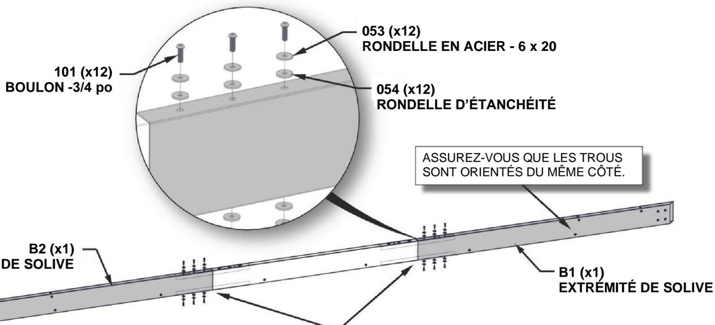
GLISSEZ B1 ET B2 SUR LE SUPPORT D'ENTURE ET MONTEZ L'ASSEMBLAGE AVEC LE CARTON D'EMBALLAGE EN DESSOUS. TAPEZ DOUCEMENT L'ASSEMBLAGE SUR LE CARTON JUSQU'À CE QUE L'ÉCART SE FERME ET SERREZ TOUS LES BOULONS SUR LA SOLIVE.
