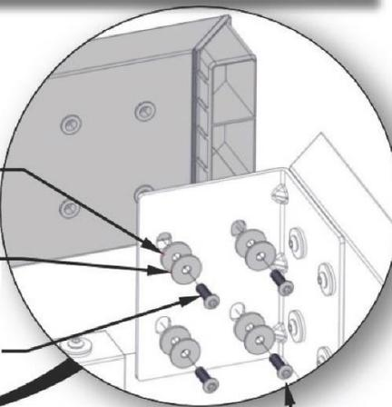
SERREZ LES BOULONS INFÉRIEURS À LA MAIN AVEC UNE CLÉ
